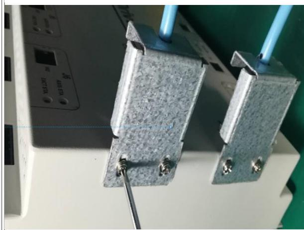
4、编码器线缆屏蔽层压入到屏蔽夹，I/O和电机抱闸线缆用扎带绑到托架上。
