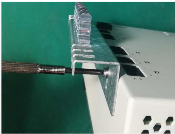
3、网线接好后，取出网线卡扣，压住网线，对准安装孔，用M3螺钉固定。
