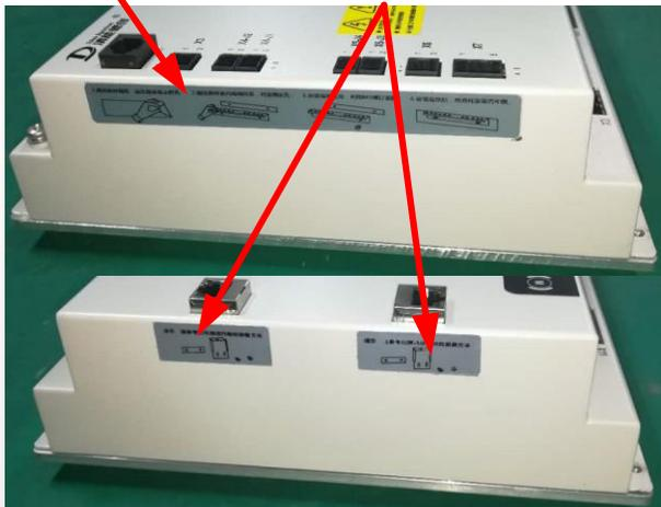
2、取出线缆托架，对准安装孔，用M3螺钉固定。
